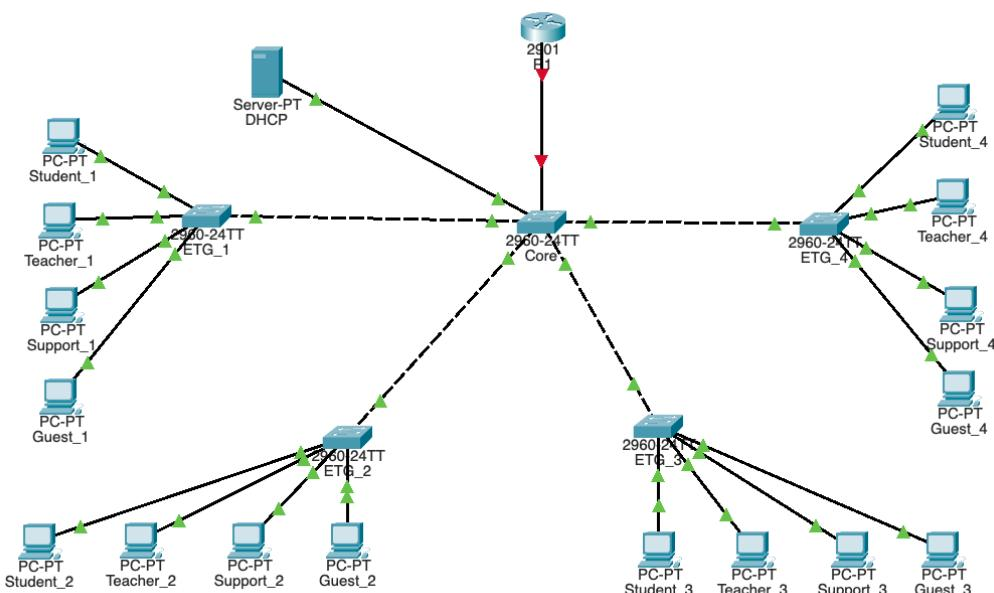
La topologie ci-dessus représente une architecture réseau d'établissement scolaire. Elle est composée des éléments suivants : un routeur Cisco 2901 **R1**, cinq commutateurs Cisco 2960 **Core**, **ETG\_1**, **ETG\_2**, **ETG\_3**, **ETG\_4**. Le réseau est segmenté en cinq VLAN, chacun correspondant à un type d'utilisateur :
